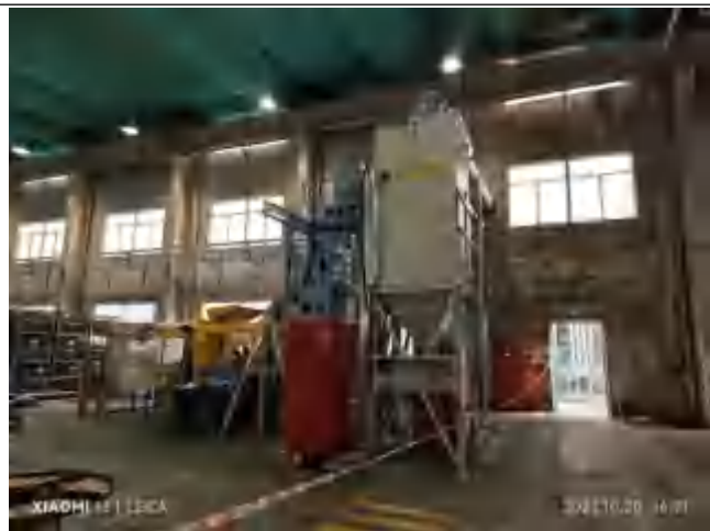
老厂区喷砂废气 DA062 排放口及对应废气处理设施、生产设备
