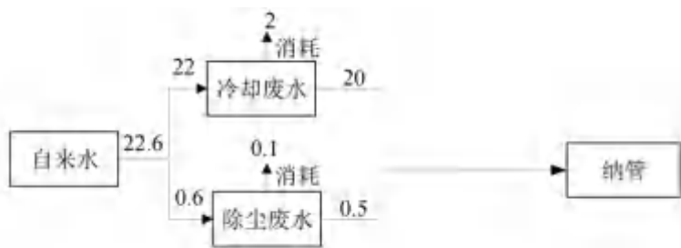
图 2-1 本项目水平衡图 (t/a)
