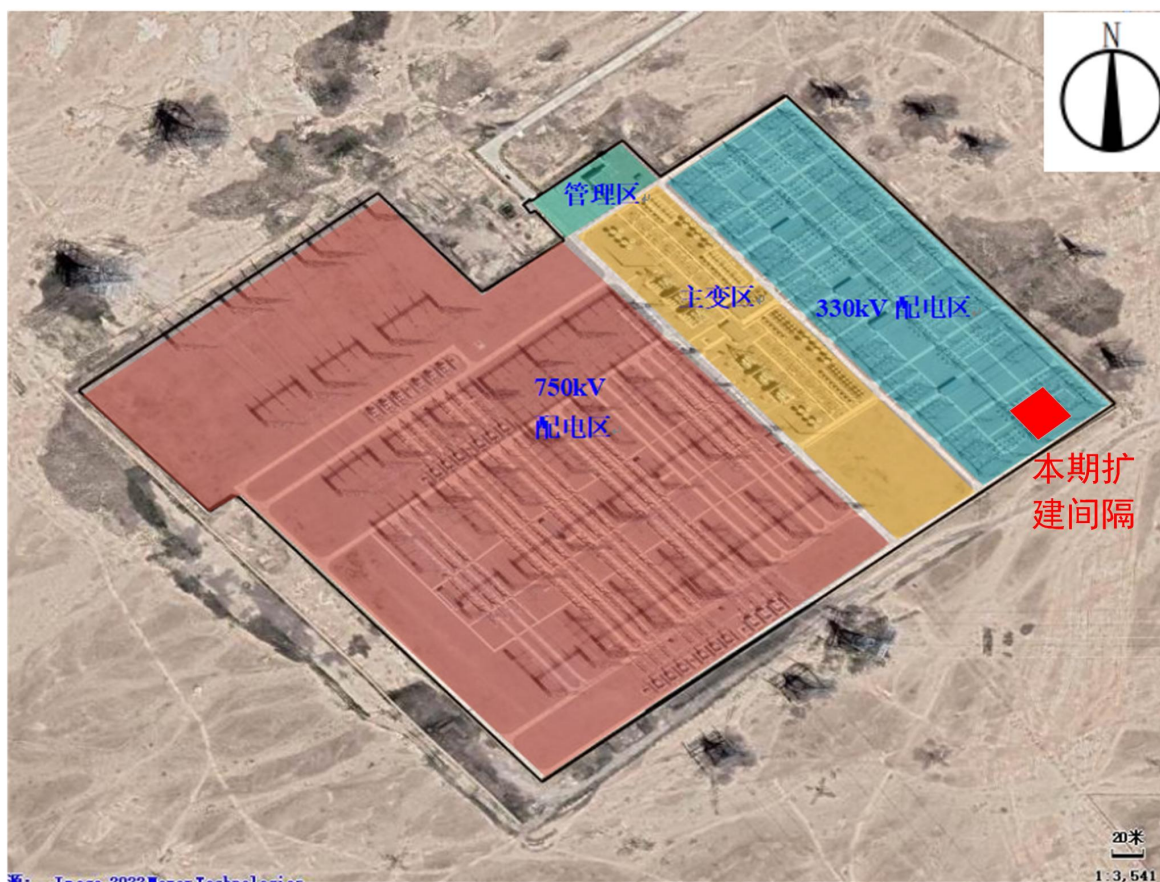
图 3.1-1 河西 750kV 变电站总平面布置图
