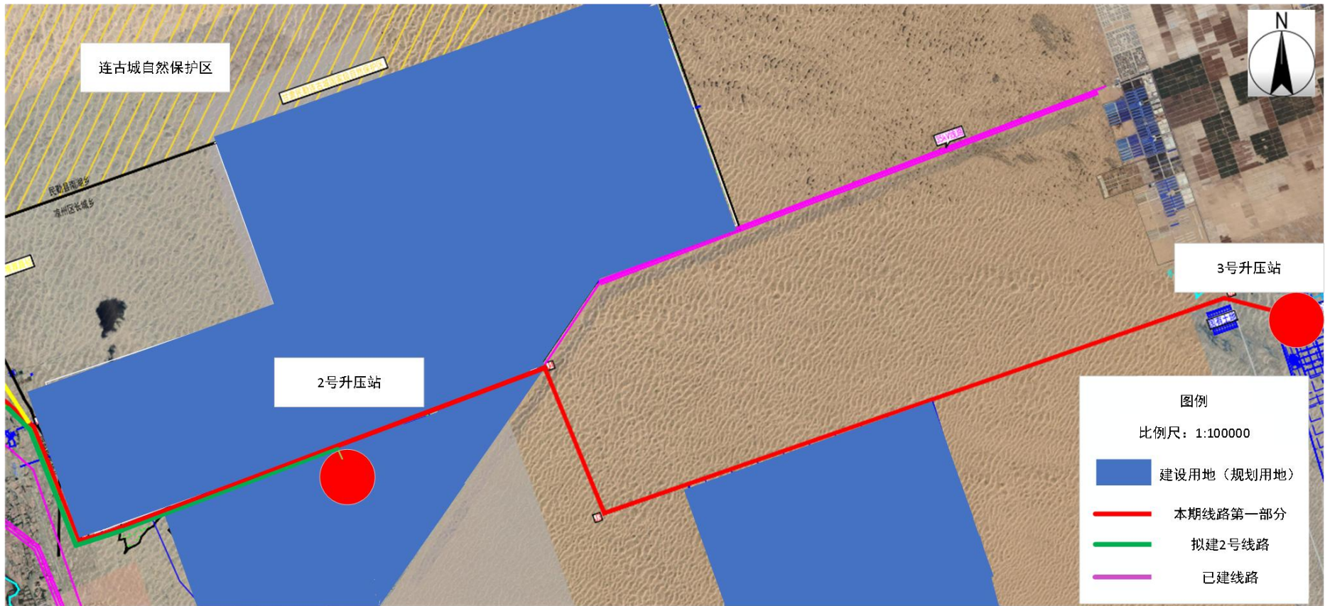
图3.5-1 第一部分走线-升压站至沙漠地段 (凉州区自然资源局指定路线)
